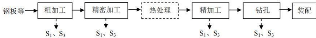
图4-9 模具机修工房工艺流程及产污环节图
